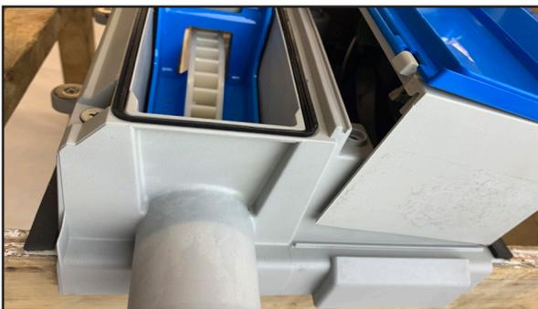
15. Con la cubierta del EECA abierta, coloque cuidadosamente el EECA en el Centro Modular Eléctrico.
