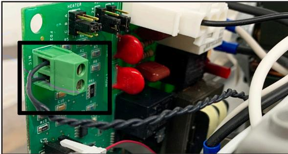
11. Instale los 2 cables en las terminales y utilice el desarmador pequeño plano para apretar los tornillos.
