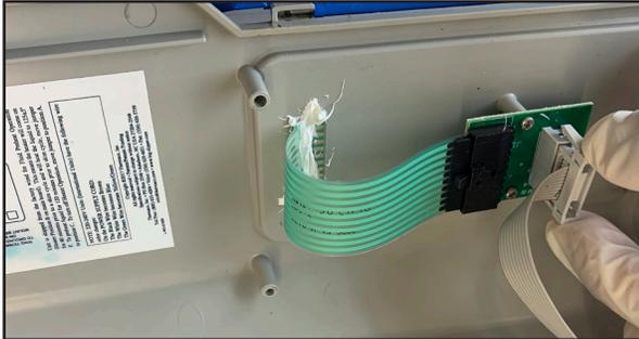
5. Desconecte la cinta electrónica del adaptador interfaz.
