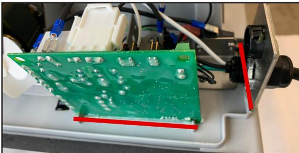
13. Asegúrese que la tarjeta electrónica y la placa eléctrica estén alineadas y sujetadas en la ranura correspondiente antes de colocar el EECA.
