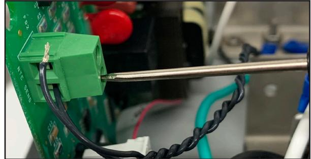
6. Utilizando el desarmador pequeño plano, afloje los (2) tornillos y retire los cables del termistor.
