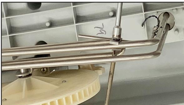
9. Asegure el nuevo termistor en la abrazadera utilizando el desarmador de cruz y el desarmador hexagonal 5/16 para asegurarlo en la abrazadera.
