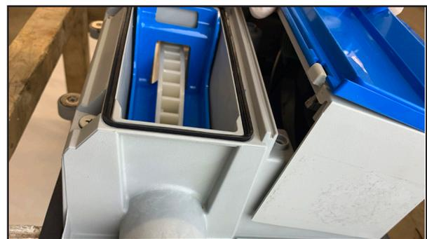
4. Levante la cubierta sobre la rueda para abrir y levantar cuidadosamente el EECA y removerlo del Centro Modular Eléctrico.
