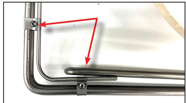
10. Las abrazaderas del termistor deben estar en la posición que se ilustra.
