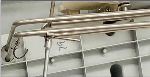
7. Gire el modulo central y utilice un desarmador de cruz y un desarmador hexagonal 5/16 para remover las (2) abrazaderas que sostienen el termistor.
