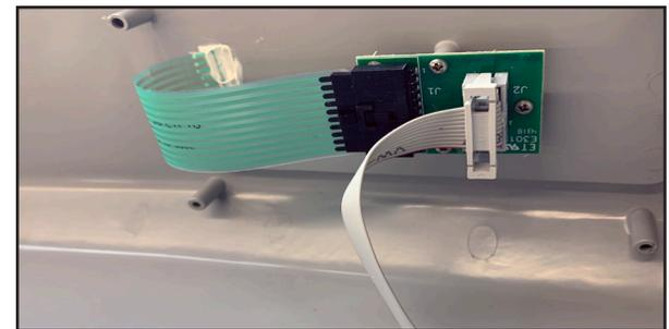
14. Conecte la cinta electrónica al adaptador interfaz.
