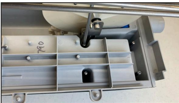
3. Utilice el desarmador de cruz y afloje los (5) tornillos y retirelos a un lado.
