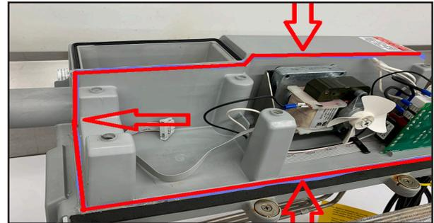
12. Usando el sellador provisto, aplique el sellador a lo largo de la ranura de la cubierta EECA y el módulo central como se ilustra en la imagen superior.
