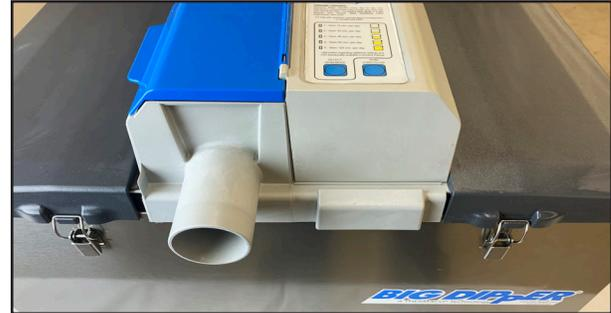
18. Coloque el Centro Modular Eléctrico en el tanque del Big Dipper, asegúrese que el nivel de agua del tanque es adecuado y abroche las cubiertas. Coloque el recipiente de la grasa en el canal.
