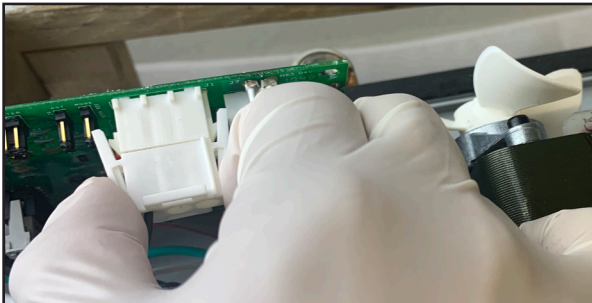
13. Precione la pestaña y conecte el cable del motor.
