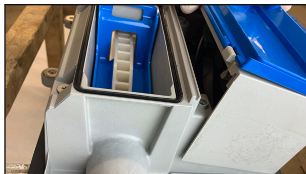
16. Desconecte y remueva el centro modular eléctrico del tanque Big Dipper y mueva el módulo central a un espacio de trabajo adecuado. Levante la cubierta EECA y desconecte la cinta del Interfaz del botón del EECA.
